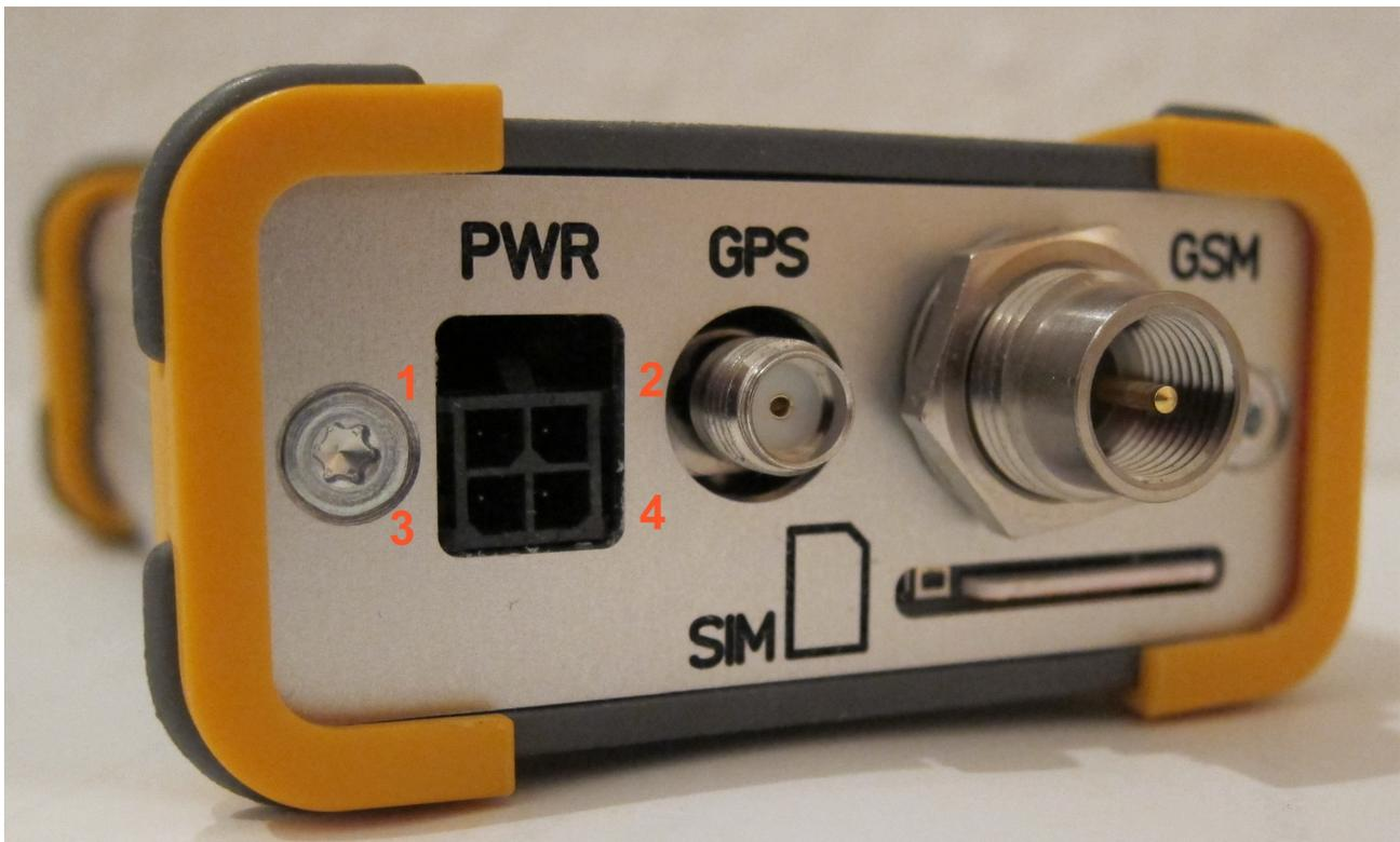
GPS-Antenne      passive oder aktive GPS-Antenne (für Spannung 3,3V DC)
