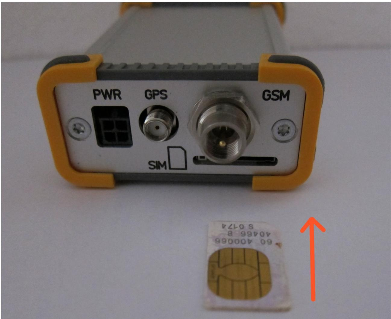
ACHTUNG - die SIM kann beschädigt werden, wenn sie eingesteckt oder entnommen wird, während das GSM-Modem eingeschaltet ist !
